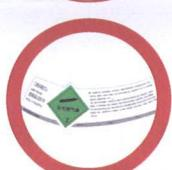
确保气瓶或其外包装上粘贴符合《气瓶警示标签》(GB16804)要求的气瓶警示标签、产品合格证等。
